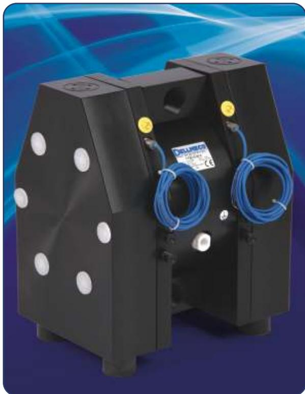
В соответствии со стандартами для высокой степени защиты, в системах с барьерной камерой стандартные мембраны заменяют на, расположенные друг за другом две мембраны и барьерной камерой из токопроводящего РЕ между ними, заполненной неэлектропроводной жидкостью.
