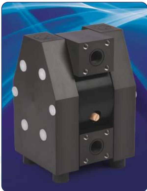
Эта версия дает возможность использовать фланцевые соединения, соответствующие стандарту DIN/PN10. Резьбовые втулки сделаны из нержавеющей стали и вмонтированы в корпус входа/выхода. Предназначены для фиксации фланцев. O-образные кольца прилагаются. Они должны вставляться в углубления в патрубках для лучшего уплотнения соединений.
