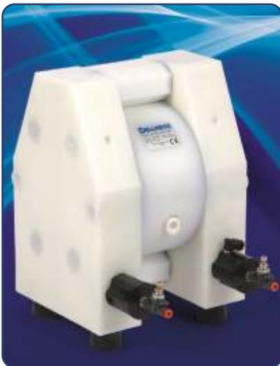
Далее демонстрируется пневматическая промывочная система (коды BF4, BF5, минимальное давление 3 bar). Благодаря подключенным 2-4-ходовым клапанам (не входят в комплектацию), обратная промывочная система может включаться автоматически при попадании каких-либо частиц в насос, мешающих его работе.
